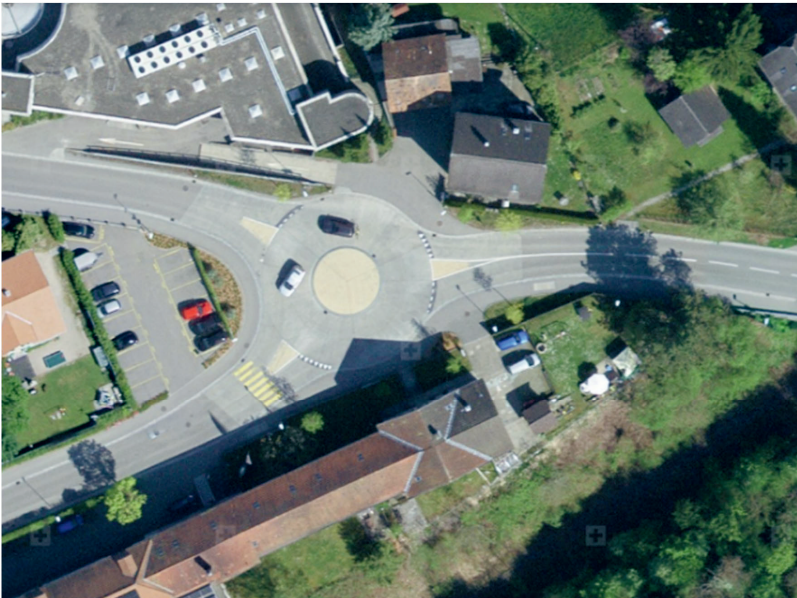
Abbildung 4; Referenzbild eines Kleinkreises mit 26 m Durchmesser in Büren an der Aare (Quelle: maps.admin.ch)
